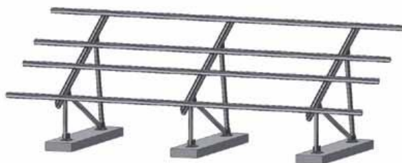
Figure 6 : Exemple de châssis fixés sur des longrines en béton
